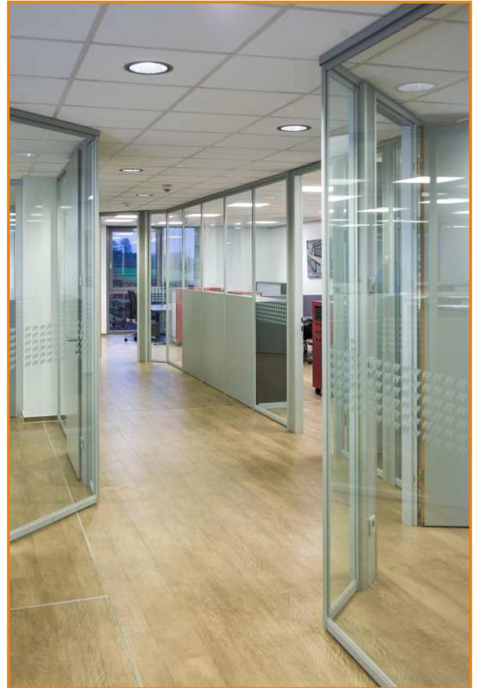
Trennwände mit raumhohen Zimmertüren mit 37 dB Schallschutz.
